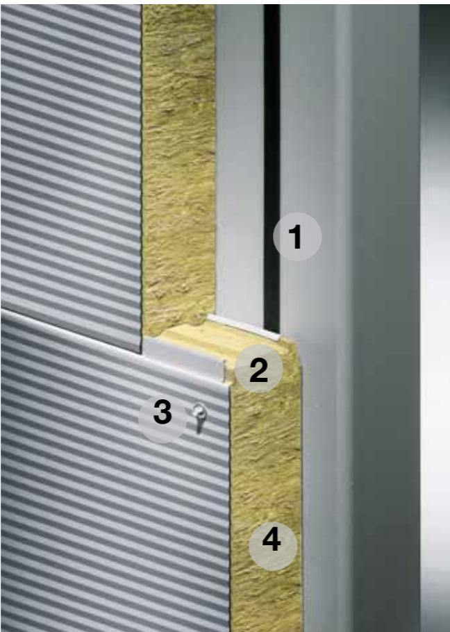
Aus hohen Anforderungen im modernen Fassadenbau wurde das FE-Paneel entwickelt. Das hocheffektive Wanddämmpaneel besteht aus einem nicht brennbaren Steinwollkern. Der Dämmkern aus steggerichteten Mineraalfasern ist mit den beiden feuerverzinkten und band beschichteten Stahlblechen schubfest verbunden. Durch die Labyrinthfräzung entsteht nach Zusammenbau ein Verbundelement ohne Kältebrücken mit geringem Eigengewicht.
