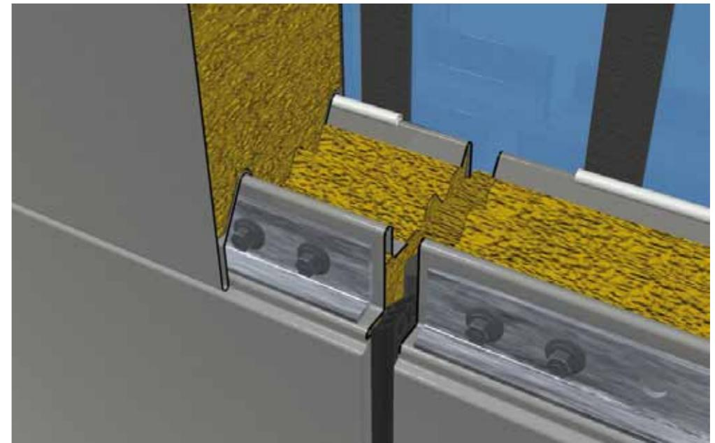
\* Steinwoll-Dämmplatte: Biolöslich TRGS 905 zugelassen nach neuester Gefahrenstoffverordnung und EU-Richtlinie V.N.R.7.1.(1.), Rohdichte  $\geq 140 \text{ kg/m}^3$
