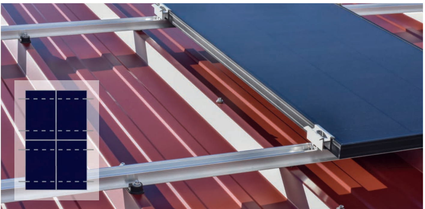
Anwendungsbeispiel: Auf der Ondatherm®-Rippe befestigter GFK-BasicClip zur Einlegemontage der K2 BasicRail inkl. Verlegeschema (Grafik)
