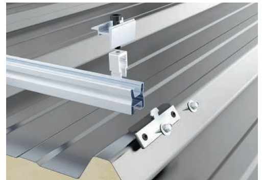
SingleFix mit Schraubenbefestigung im Steg der Paneelrippe, Schletter-Schiene und passender Modul-Klemme
