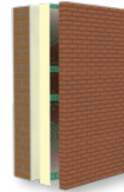
Kerndämmung im zweischaligen Mauerwerk
